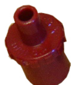
Bild 4b. 4.5 mm motståndet som har utgått
